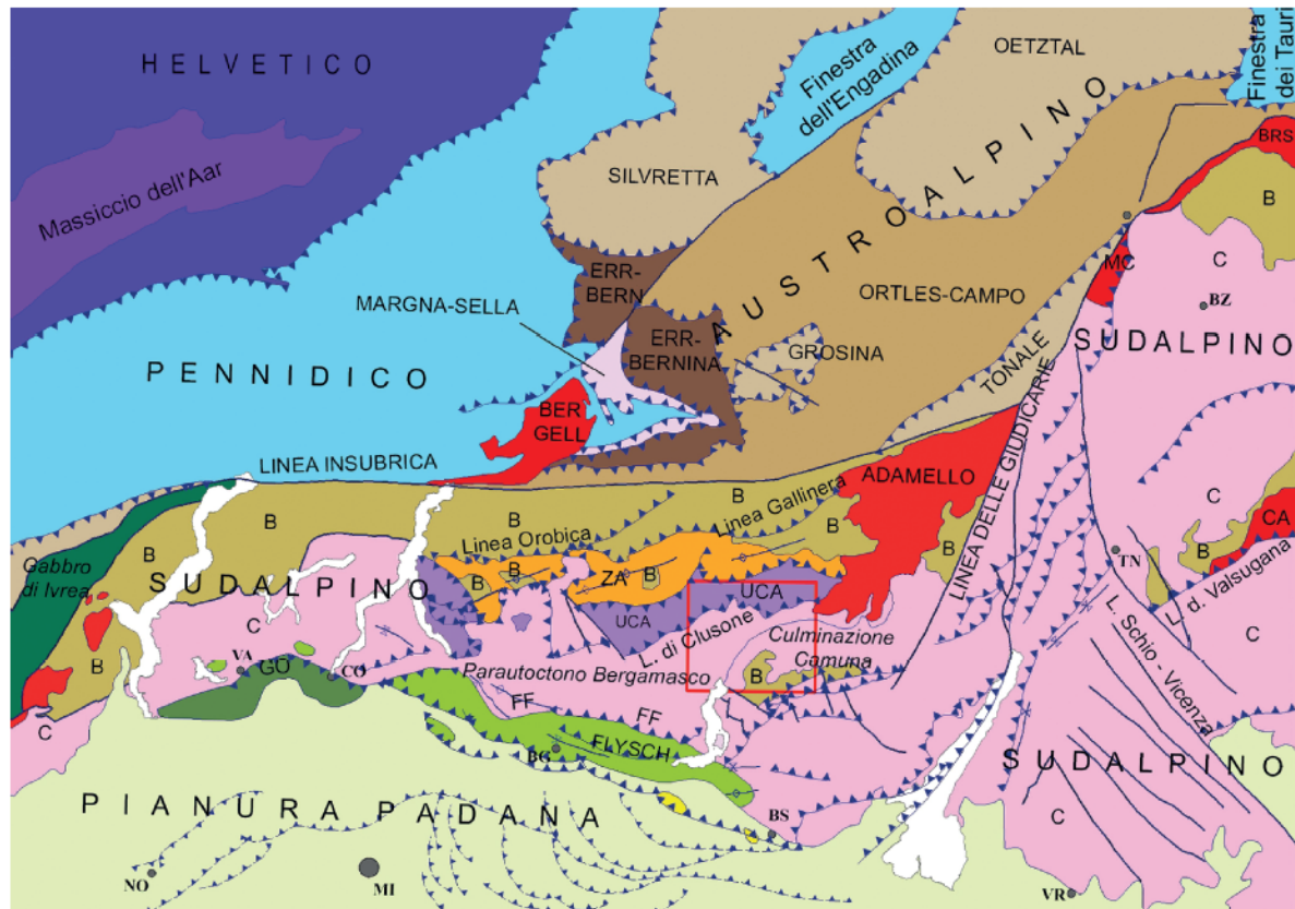
Fig. 2 – Schema tettonico delle Alpi Centrali e delle Alpi Meridionali (Sudalpino). La cornice indica la posizione del Foglio 078-Breno. (Oetztal-Silvretta-Tonale-Grosina: Austroalpino Superiore, Ortles-Campo: Austroalpino Medio, Margna e Sella e Err-Bernina: Austroalpino Inferiore, B: Basamento Metamorfico Sudalpino, C: Coperture Sudalpine Parautoctone, UCA: Unità Carbonatiche Sudalpine Alloctone, ZA: Zona delle anticlinali orobiche, FF: Fascia della Flessura Frontale o Flessura Pedemontana, FLYSCH: Cuneo clastico del Cretacico Superiore, GO: Cuneo clastico Oligo-Miocenico della Gonfolite e cunei successivi più orientali, Bergell: Plutone Terziario omonimo, Adamello: Batolite dell'Adamello, BRS: Plutone terdo-ercinico di Ivigna-Bressanone, MC: Plutone tardo-ercinico di Monte Croce, CA: Plutone tardo-ercinico di Cima d'Asta).
